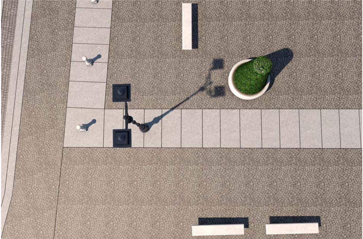
Particolare pavimentazione in porfido e lastre in progetto – parte centrale
